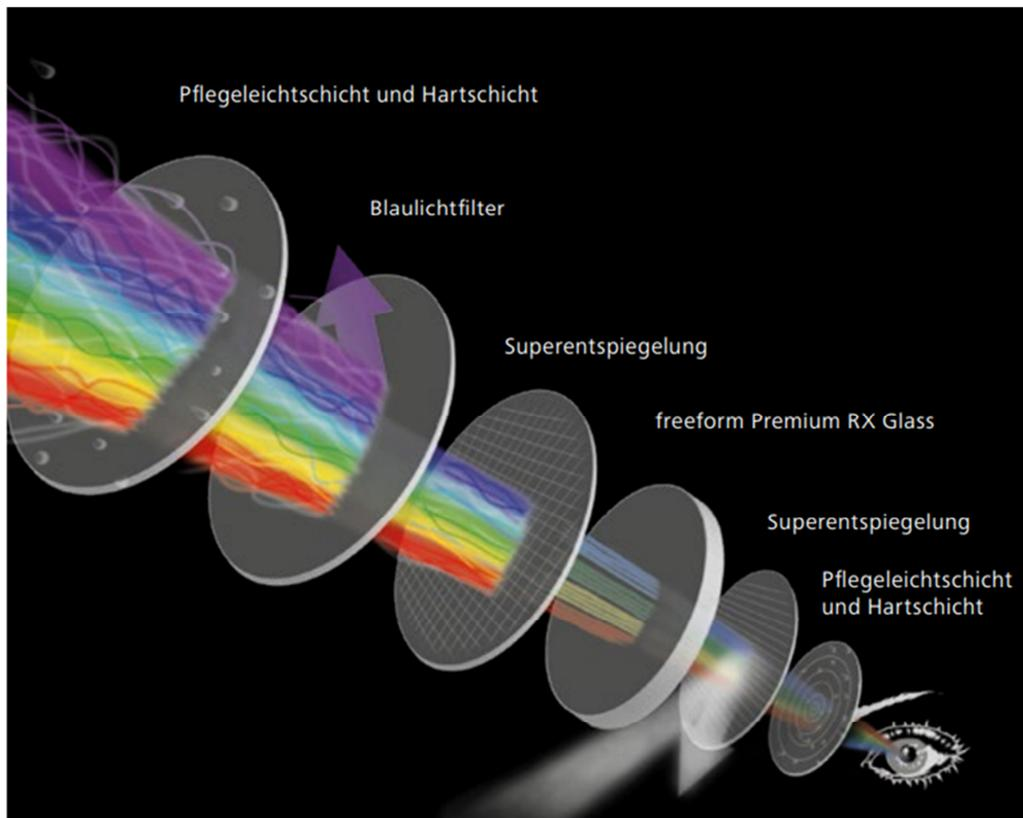
*ForSec Schutzgläser bestehen aus mehreren Veredelungsschichten, die optimale Haltbarkeit und Sehkomfort erzeugen (Grafik © ForSec).*
